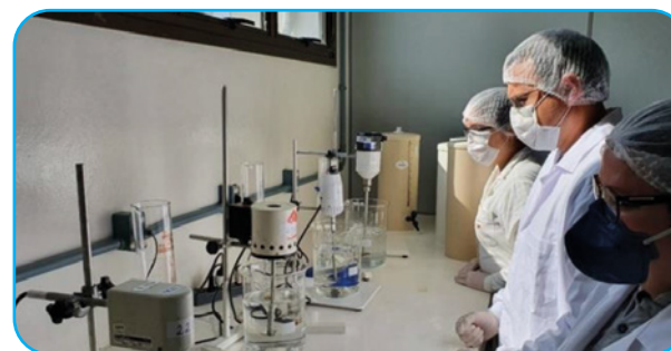
Fig. 1 – Produção de álcool glicerinado 70° INPM no Centro Integrado de Análises (CIA-FURG).
